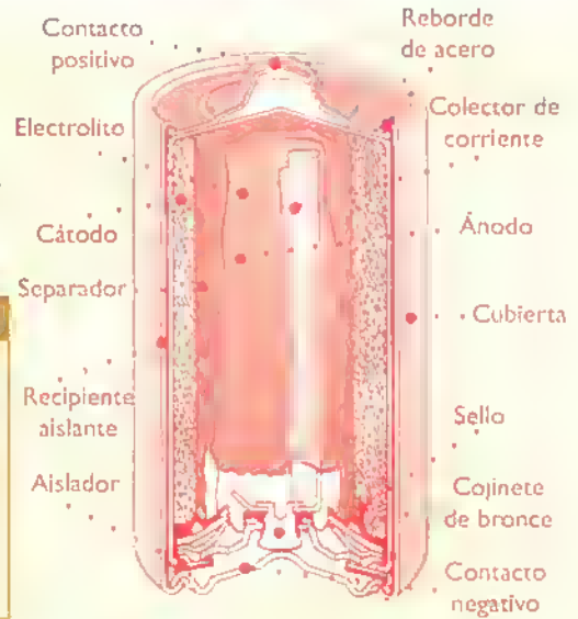
Figura 6.31. Estructura interna de una pila seca
